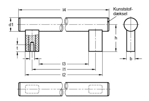
b = 18 t min = 15 d1 = 30 d2 = M8 h = 60 l1 = 600 l2 = 630 l3 = 570 l4 = 665
